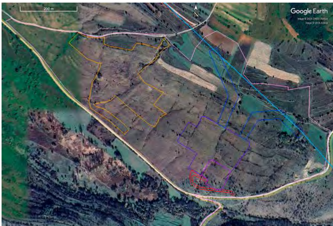
Слика 13. Елементи плана прикључка на електромережу пројекта СЕ Brebex : парцела планирана за инфраструктуру прикључка на електромережу (розе) са позицијама ТС (љубичасто), ПРП (плаволубичасто), прикључног ДВ (тамноплаво), постројења за складиштење електричне енергије (наранџасто) и приступног пута (црвено), и траса подземног повезног вода (ружичасто); приказана је и траса постојећег ДВ преко ког је планиран прикључак (светлоплаво). Извор: GoogleEarth 2024, Sage Solutions, са модификацијама И. Карапанџа, Б. Карапанџа, оригинал.
